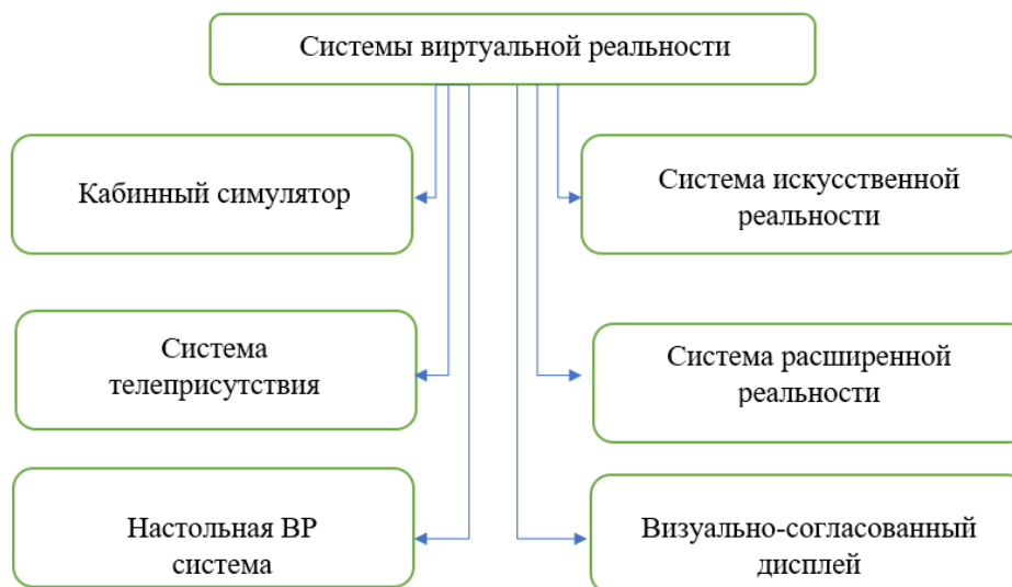
Рис. 2. Типы систем виртуальной реальности
