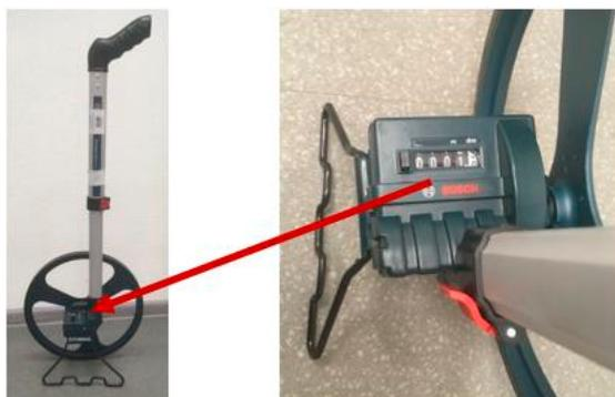
*Рис. 13. Измерительное колесо*
