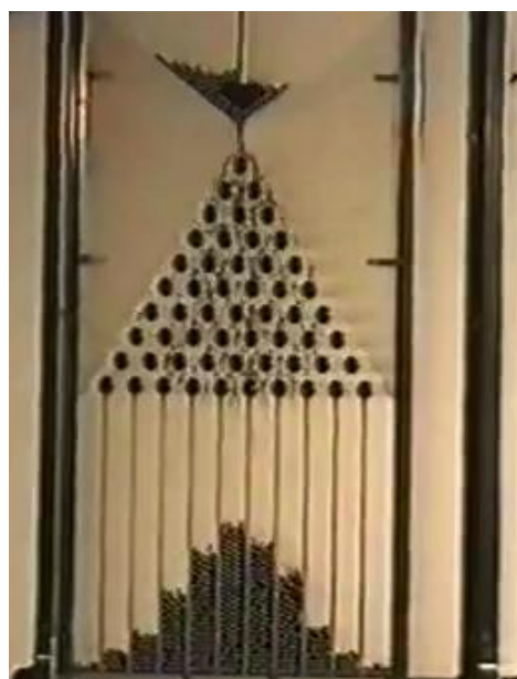
Рис. 10. Демонстрация нормального распределения при помощи доски Гальтона
