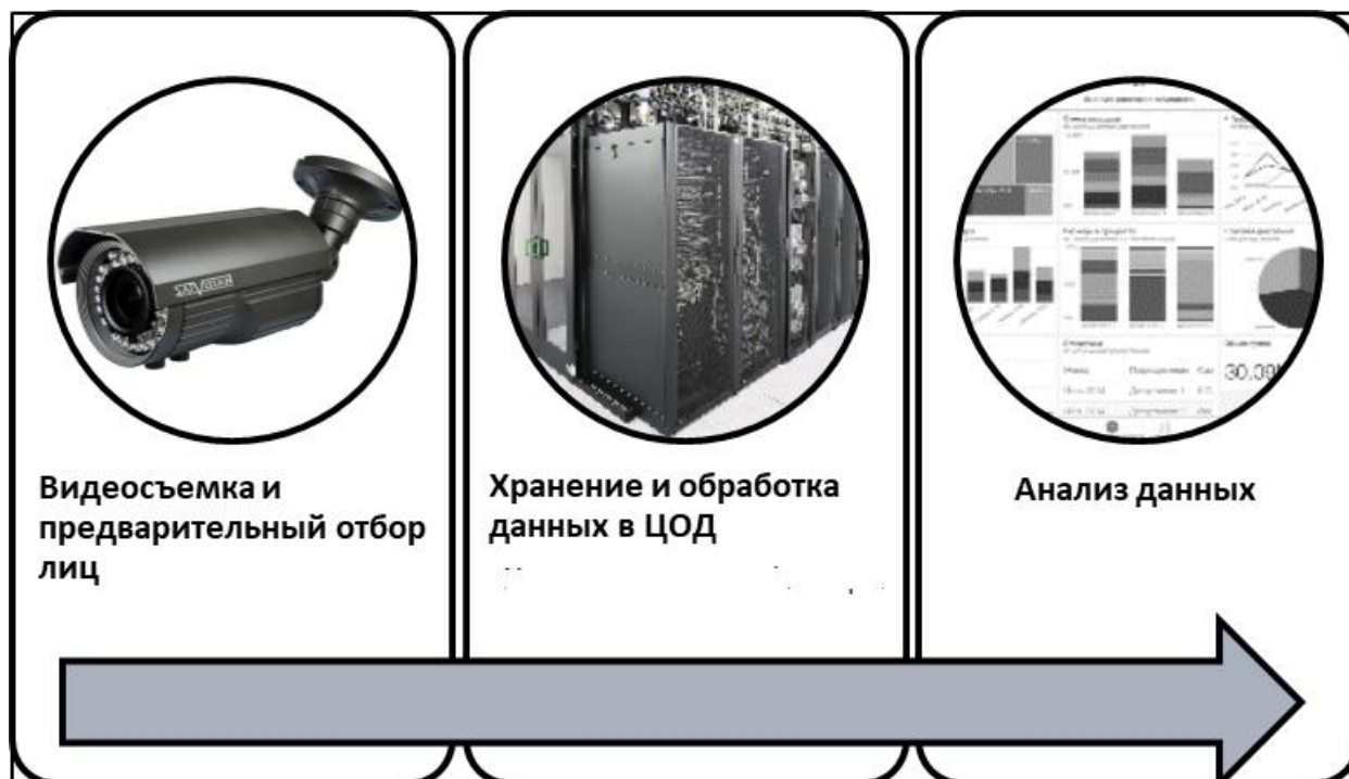
Рис. 2. Функциональная модель процесса распознавания лиц
